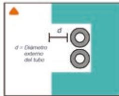
Para instalar la tubería en paredes anchas se emplea una cobertura de cemento en un espesor igual o superior al diámetro del tubo.
